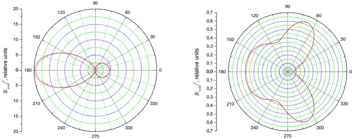
Рис. 1: Полярная диаграмма квадрата модуля рассеянного электрического поля на расстоянии, в полтора раза превышающем радиус цилиндрической полости. Слева — полость в золоте,  $\varepsilon_h = -8.325 + i1.325$ , длина волны 600 нм; справа — полость в поглощающем диэлектрике,  $\varepsilon_h = 13.7 + i2.0$ , длина волны 850 нм. Сплошная кривая — метод дискретных диполей, пунктир — аналитическое решение.
