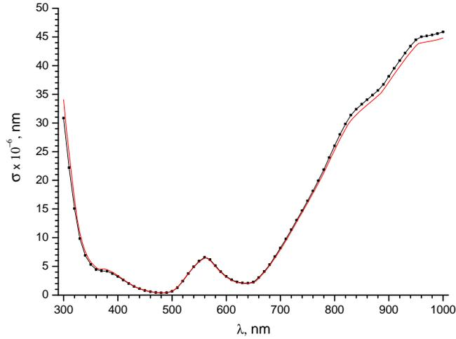
Рис. 2: Зависимость сечения рассеяния (на единицу длины вдоль цилиндра) цилиндрической полости в золоте от длины волны падающего излучения. Сплошная кривая — метод дискретных диполей, пунктир — аналитическое решение.
