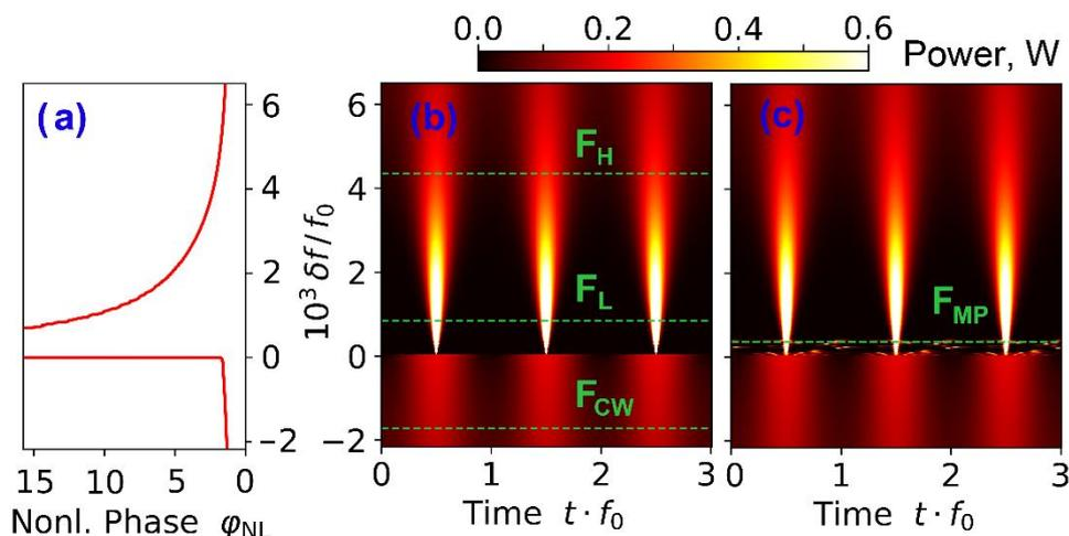
Полученная в численном моделировании эволюция импульсной генерации, обусловленная подстройкой частоты модуляции накачки вблизи фундаментальной частоты повторения  $f_0$ ; (a) – набег нелинейной фазы в зависимости от относительной расстройки частоты модуляции  $\delta f / f_0$ ; (b, c) – временные распределения мощности лазера при перестройке частоты модуляции в положительном и отрицательном направлениях.
