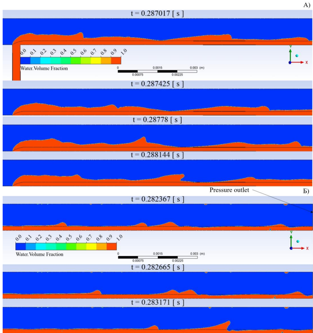
Рис. 3. Динамика распространения возмущений в жидкости А) вблизи смесителя, Б) на выходе из канала. Красный цвет – объемная доля жидкости 1, синий – объемная доля газа 1, скорость газа на входе v_{gas} = 25 м/с, скорость жидкости на входе v_{liq} = 1 м/с.
