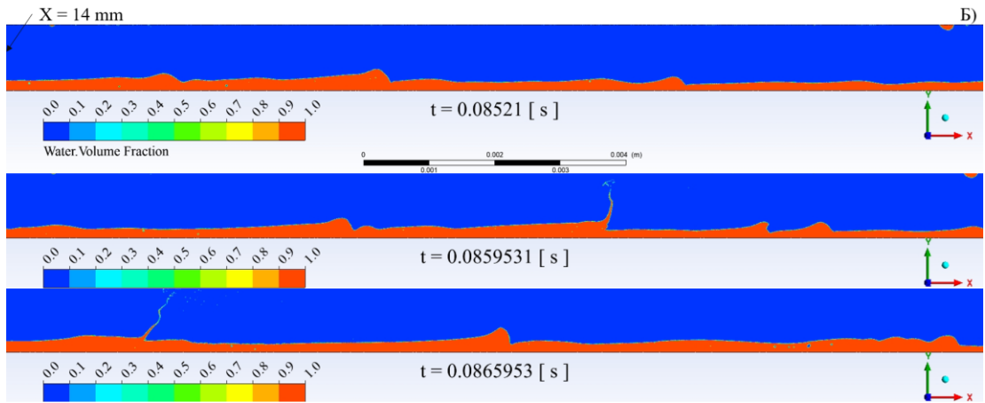
Рис.4. Динамика возмущений в жидкости А) вблизи смесителя, Б) На расстоянии X = 14 мм от смесителя. Красный цвет – объемная доля жидкости 1, синий – объемная доля газа 1, скорость газа на входе v_{gas} = 35 м/с, скорость жидкости на входе v_{liq} = 1 м/с.
