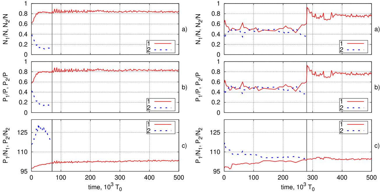
Рис. 2: Зависимость от времени числа частиц (а), импульса (b) и характерного волнового числа (с) в первом сценарии эволюции системы (слева) и во втором сценарии (справа). Черные вертикальные прямые показывают момент времени исчезновения одного из бризеров.
