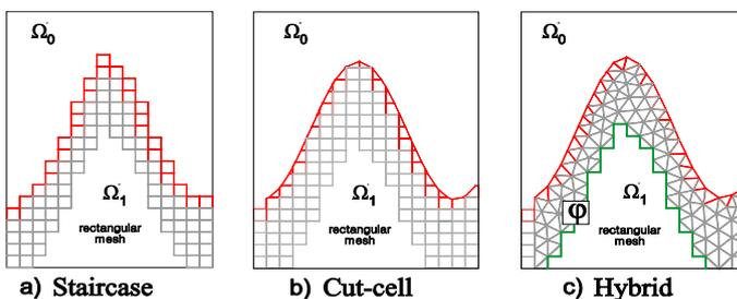
**Рис.2:** Способы аппроксимации переменного рельефа местности.
