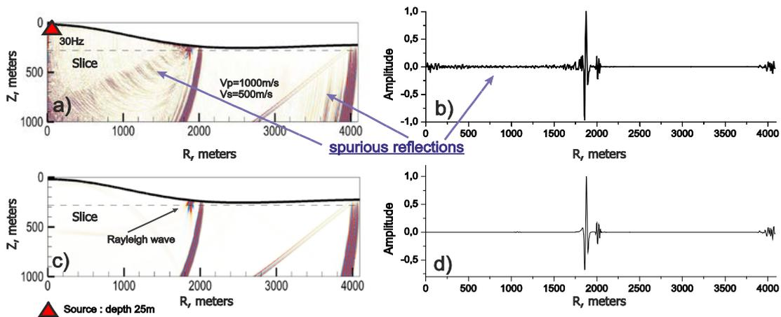
**Рисунок 4.** Мгновенный снимок волнового поля для компоненты  $u_r$  для ступенчатой (a) и гибридной аппроксимации (c) в момент времени  $t = 4.25s$ . Зависимость амплитуды от координаты  $r$  вдоль прямой "Slice" для ступенчатой (b) и гибридной аппроксимации (d).
