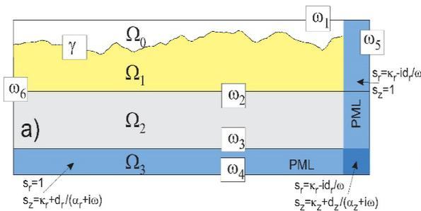
**Рисунок 1:** а) Декомпозиция расчетной области на подобласти, для которых используются различные процедуры решения разностных уравнений
