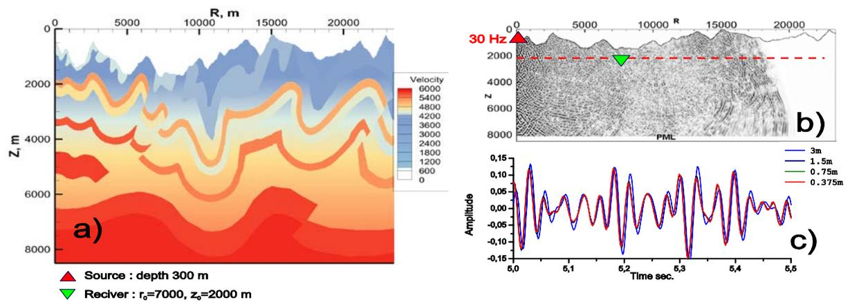
**Рисунок 5:**(a) Модель среды the Canadian Foothills, (b) мгновенный снимок акустического волнового поля в момент времени, (c) зависимость амплитуды волнового поля для приемника от времени для гибридной сетки различной подробности.
