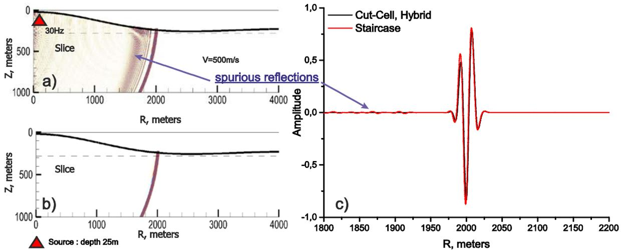
**Рисунок 3.** Мгновенный снимок акустического волнового поля в момент времени  $t=4.25s$  для (a) ступенчатой (b) гибридной и скошенных ячеек аппроксимации рельефа, (c) зависимость амплитуды вдоль линии "Slice".
