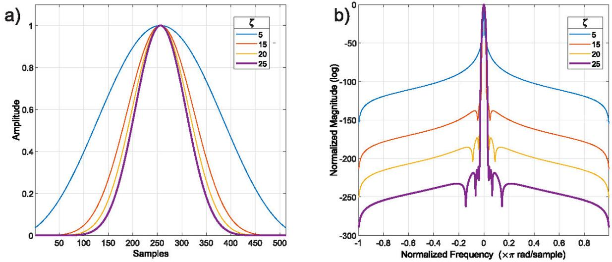
Рис. 2: Весовая функция Кайзера для различных значений параметра  $\zeta$ , а) временная область и б) частотная область
