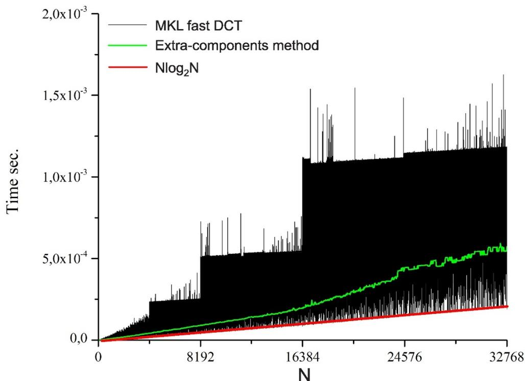
Рис. 4: Зависимость времени счёта вычисления дискретного косинус-преобразования от размерности  $N$
