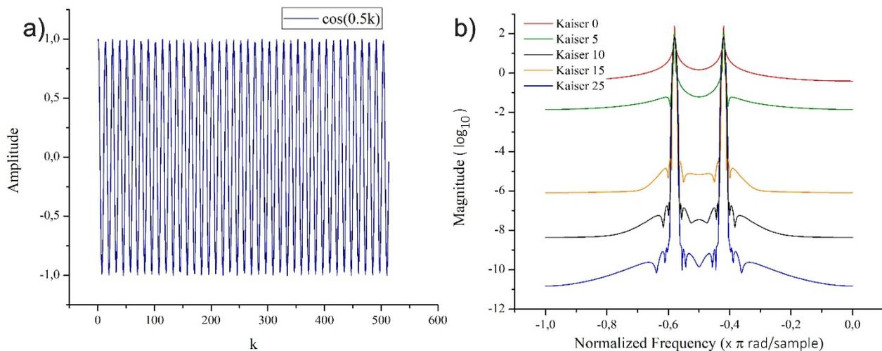
Рисунок 1: а) График строки  $A_1$ , где отдельные точки соединены линиями; б) абсолютные значения коэффициентов соответствующего ряда Фурье для различных весовых функций
